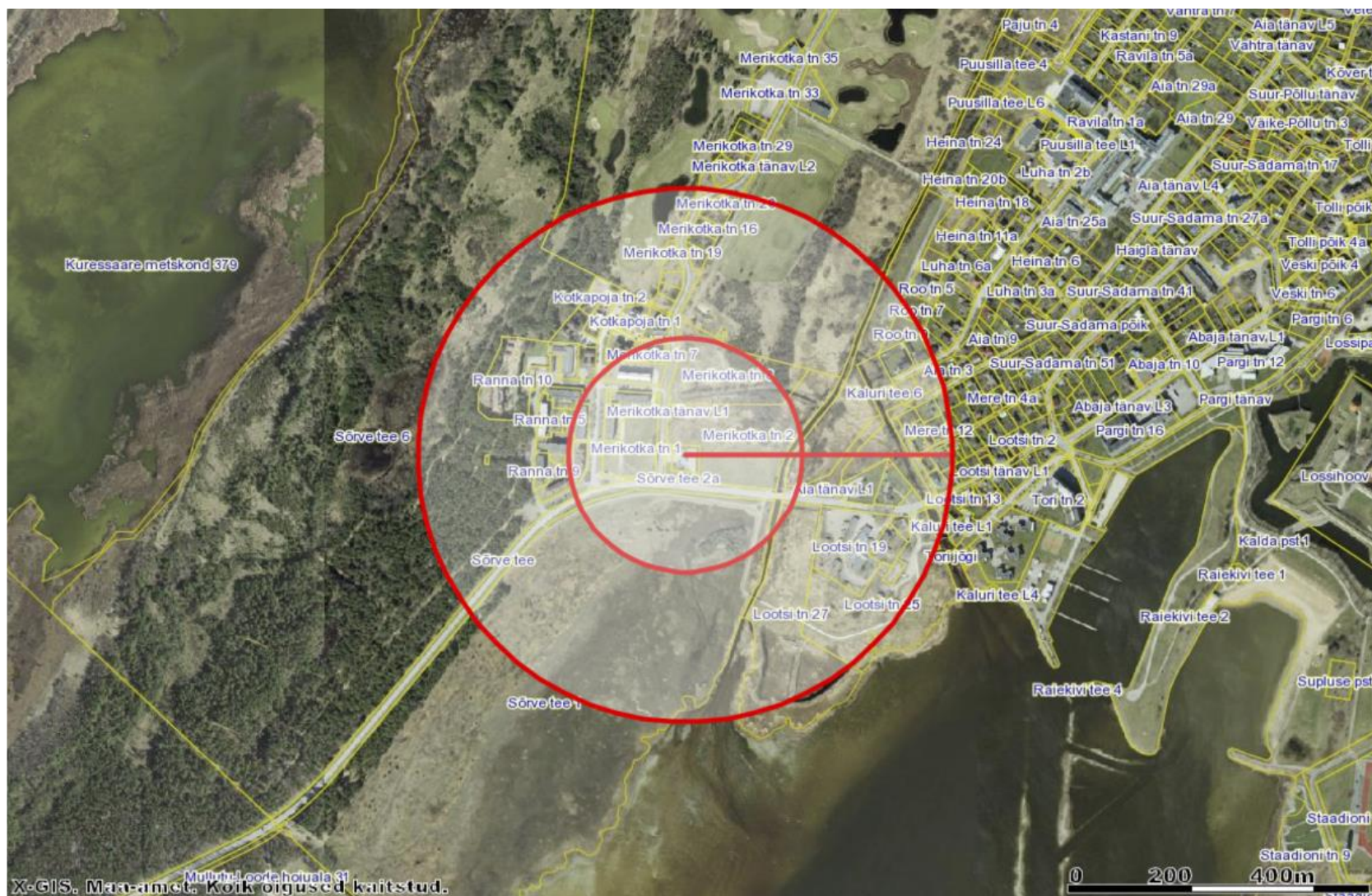
Joonis 2. Bensiini tsiternauto BLEVE ohualad: ehitistele 434 m, inimestele 190 m
