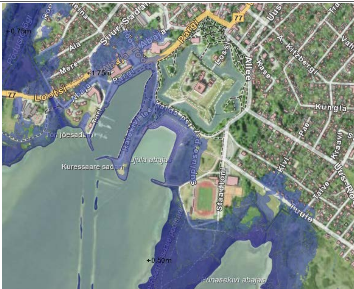
Joonis 12. Kuessaare mereäärse üleujutusala. Tähistatud on kriitiline piir +170 cm. 22.02.2020 oli merevee tase umbes +120 cm. Allikas maa-ameti geoportaal.
