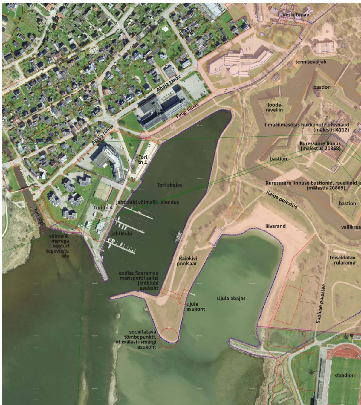
Joonis 13. Kavandatavad tegevused planeeringualal ja selle lähiümbruses (detailsemalt ja tingmärkide seletusega näidatud joonisel lisas, vt Lisa 1: Detailplaneeringu ala joonis, lk 53). Sinise katkendjoonega näidatud detailplaneeringuala piir, rohelise joonega kaugvaatesektorid, punase katkendjoonega kavandatavad ehitised, sh Tori jõe kaldal, kergliiklusteed lõuna ja lääne suunas, hooned Tori tn 4 krundil, Raiekivi poolsaarel, Veski tänavas ning rulapargi kolm alternatiivset asukohta staadionist loodes ja läänes. Aluskaart: maa-ameti ortofoto ja ruumandmed.
